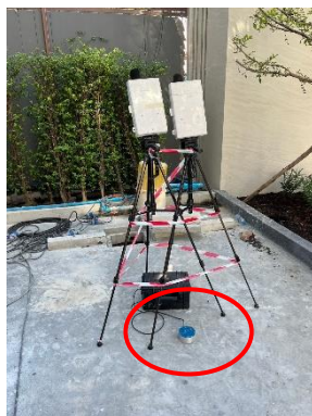
รูปที่ 3.15 การตรวจวัดความสั่นสะเทือนภายในพื้นที่โครงการ
